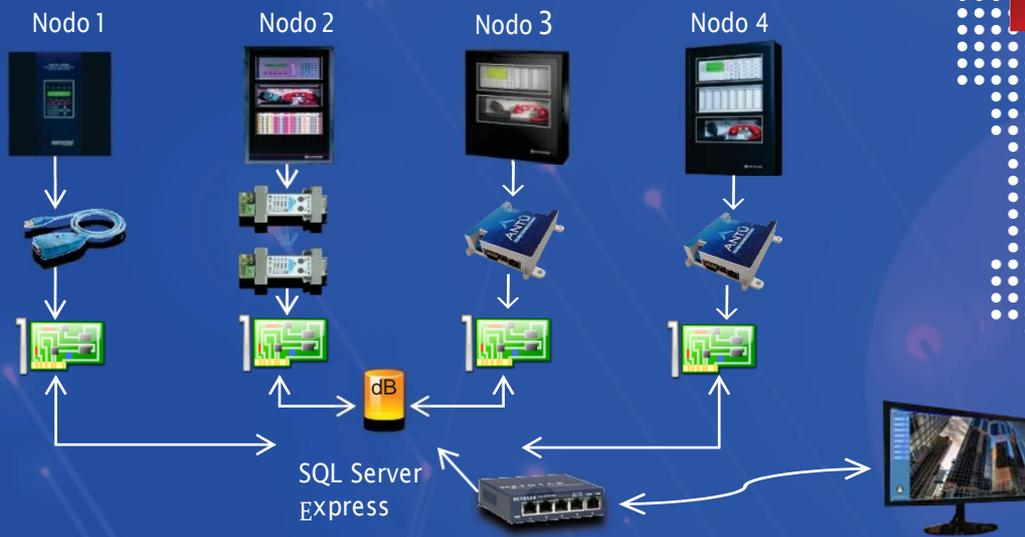
Conversión de los mensajes reportados por la central de incendio de RS-232 a TCP/IP a través de una red Ethernet para el monitoreo Remoto. En comunicaciones seriales para extender la red, es posible utilizar convertidores RS-232 a RS-485.
